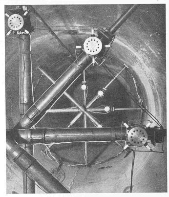
Bild 3. Einrichtungen zum Messen der radialen Deformationen des Panzerrohrs in der Versuchskammer Rothenbrunnen
