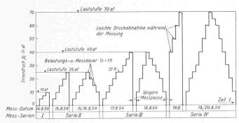
Bild 4. Belastungsdiagramm des Panzerrohrversuchs Rothenbrunnen (ohne Vorbelastungen im Bereich von 0 bis 8 at, zur Ermittlung der Klaffung)
