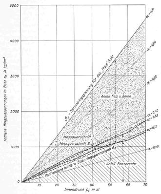
Bild 7. Lastverteilungsdiagramm des Panzerrohrversuchs Rothenbrunnen
