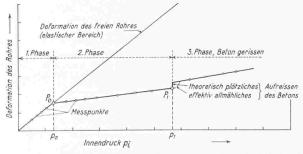
Bild 5. Idealisiertes Schema des Deformationsverlaufs bei steigendem Innendruck
