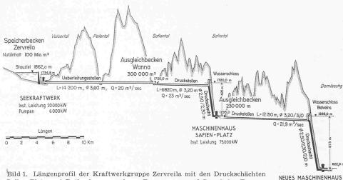
Bild 1. Längenprofil der Kraftwerkgruppe Zervreila mit den Druckschächten Safien Platz und Rothenbrunnen, deren Panzerungen auf Grund des Panzerrohrversuchs dimensioniert wurden (Längen 1: 333 000, Höhen 1: 33 300)
