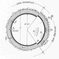
Bild 8. Bezeichnungen im Druckschachtquerschnitt
