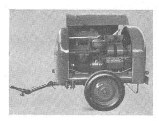
Bild 1. Fahrbare Kompressoranlage mit Hatz-Dieselmotor Type «robot» DV-20
