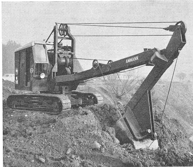
P & H-Raupenbagger mit Tieflöffelausrüstung und Kübel von 600 l Inhalt
