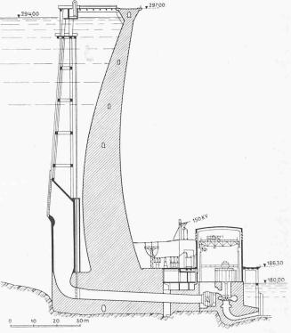
Bild 5. Querschnitt des Kraftwerkes, Masstab 1:1400
