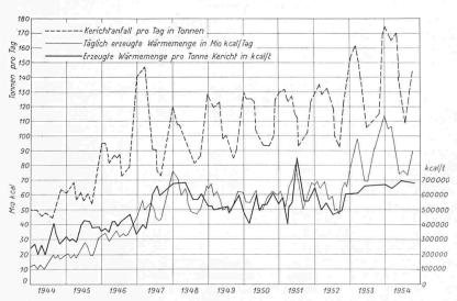
Bild 3. Kehrichtanfall in t/Tag und erzeugte Wärme in Mio kcal/Tag der Anlage in Basel im Verlauf der letzten zehn Jahre
