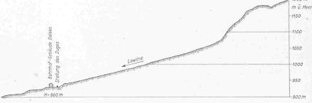
Bild 3. Längsprofil des Lawinenlaufs ob Bahnhof Dalaas (Arlberglinie), Masstab 1:8000
