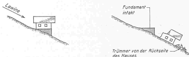
Bild 6. Schematische Darstellung der Zerstörungsart der Häuser in Blons (Bild 4) und Sonntag (Bild 5) vor und nach der Katastrophe
