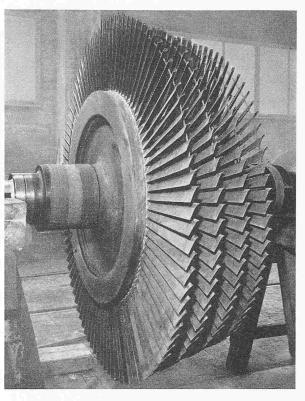
Anlässlich einer genauen Kontrolle der 13 000 kW-Gruppe nach 7900 Betriebsstunden konnte festgestellt werden, dass sich beide Gasturbinenrotoren in gutem Zustand befinden (Bilder 22 und 23). Gleichzeitig wurden auch einige Luftvorwärmerrohre ausgebaut und kontrolliert. Bild 24 zeigt ein aufgeschnittenes Rohr. Man sieht, dass die Rohre sich in sehr gutem Zustand befinden. Das Material ist in Ordnung. Es konnte keine Abnahme der Wandstärke festgestellt werden.
