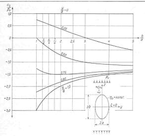
Bild 3. Tangialspannungen  $\sigma_\zeta/p_v$  in ellipsenförmigen Stollen unter vertikal wirkendem Gebirgsdruck ( $\sigma_\zeta/p_r$  als Funktion von b/a für verschiedene Parameter y/a)
