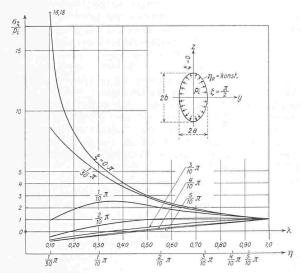
Bild 7. Elliptischer Stollenquerschnitt unter Innendruck Randspannungen  $\sigma_{\zeta}/p_i$  ;  $\lambda=\frac{a}{b}$ ; b= 1,0  $(\sigma_{\zeta}/p_i$  als Funktion von  $\lambda$  bzw.  $\eta$  für verschiedene Parameter  $\zeta$ )
