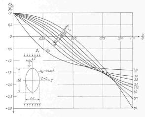
Bild 4. Tangentialspannungen  $\sigma_\zeta/p_v$  in ellipsenförmigen Stollen unter vertikal wirkendem Gebirgsdruck
