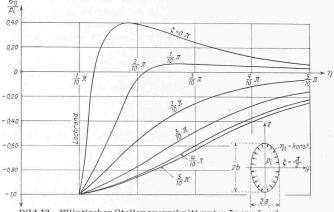
Fild 12. Elliptischer Stollenquerschnitt unter Innendruck  $\lambda=\frac{a}{b}=0.30421\;;\;b=1\;;\;\eta_o=\frac{1}{10}\,\pi\;;\;c=0.9526$   $(\sigma_\eta/p_i \text{ als Funktion von }\eta\text{ für verschiedene Parameter }\zeta)$
