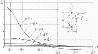
Bild 9. Elliptischer Stollenquerschnitt unter Innendruck  $\lambda=\frac{a}{b}=0.30421\;;\;b=1\;;\;\eta_o=\frac{1}{10}\,\pi\;;\;\;c=0.9526$  ( $\sigma_\zeta/p_i$  als Funktion von  $\zeta$  für vorzet.
