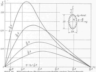
Bild 13. Elliptischer Stollenquerschnitt unter Innendruck  $\lambda = \frac{a}{b} = 0.30421$ ; b = 1;  $\eta_o = \frac{1}{10}\pi$ ; c = 0.9526
