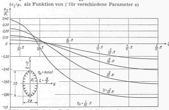
Bild 11. Elliptischer Stollenquerschnitt unter Innendruck  $\lambda=\frac{a}{b}=0.30421\;;\;b=1\;;\;\eta_o=\frac{1}{10}\;\pi\;;\;c=0.9526$  $(\sigma_{\eta}/p_i$  als Funktion von  $\zeta$  für verschiedene Parameter  $\eta)$
