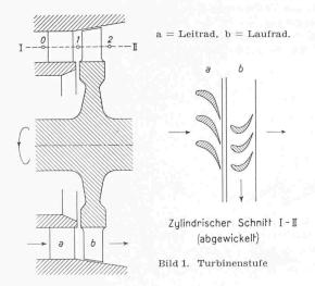
seiner Dichte. Aus Strömungsgeschwindigkeiten und Dichte folgen sofort auch die Durchflussquerschnitte, womit die Dimensionierung der Maschine möglich ist.
