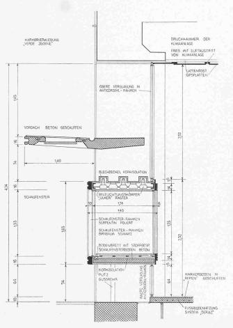
Bild 5. Isometrie des Schaufensterkastens, mit Rolle für Fenstergitter
