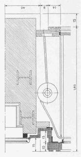
Bild 7. Anschluss des Schaufensterkastens an den Pfeiler, Horizontalschnitt 1:20
