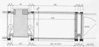
Bild 6. Horizontalschnitt Pfeiler und Schaufensterkasten, Masstab 1:50
