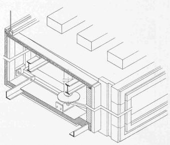
Bild 5. Isometrie des Schaufensterkastens, mit Rolle für Fenstergitter
