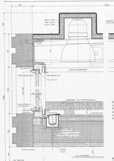
Das Profil des Schaufensterrahmens ist typisch für die Firma Gübelin. Es wird in allen Läden an Tischen, Vitrinen usw., leicht abgewandelt, wiederholt.
