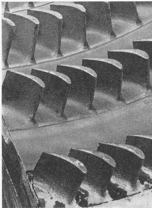
Bild 8. Schaufelträger der Hochdruckturbine, Stufen 1, 2 und 3, nach 700 h Betrieb mit Brennöl II + Zusatz und p_{\max} = 25 atü, t_{\max} = 675^\circ \text{C}
