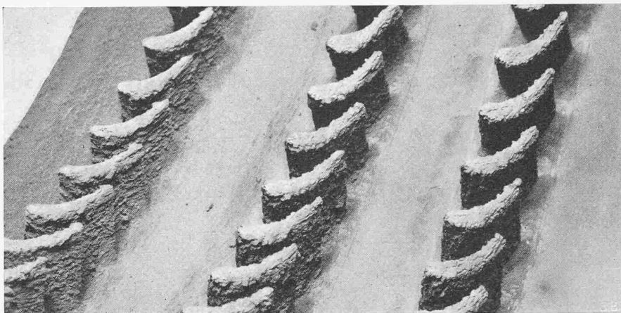
Bild 3. Schaufelträger der Hochdruckturbinen, Stufen 1, 2, 3, nach 50 h Betrieb mit Brennstoff I ohne Zusatz und p_{max} = 18 \text{ atü} , t_{max} = 630^\circ \text{C}
