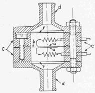
Bild 1. Indikator mit Dehnungsmesstreifen
