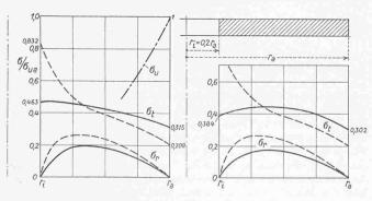
Bild 1. Verhältnismässige Tangential- und Radialspannungen einer ebenen Scheibe bei einer Kriechgeschwindigkeit  $\varepsilon=k~\sigma^5$
