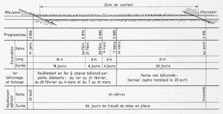
Fig. 7. Avancement des travaux
