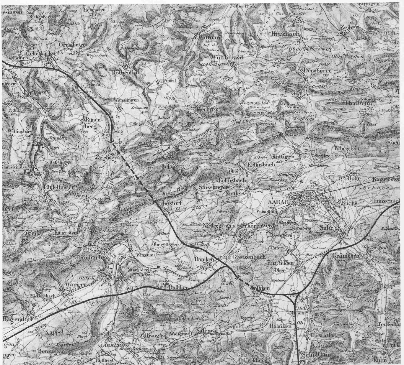
Bild 3. Einzelheiten des Vorschlags Bild 2: Das Zentrum des schweizerischen Strassenkreuzes bei Kölliken - Däniken und der 4½ km lange Jura-tunnel Lortorf - Zeglingen des Nordarms. Führung des Westarms südlich von Olten. Masstab 1:125 000.
