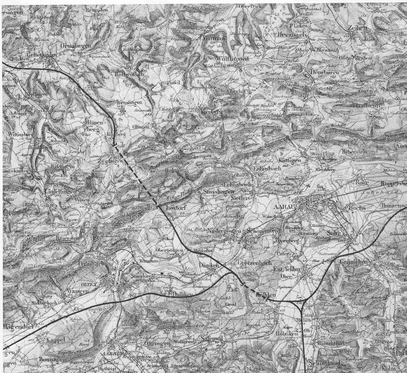
Bild 3. Einzelheiten des Vorschlages Bild 2: Das Zentrum des schweizerischen Strassenkreuzes bei Kolliken - Däniken und der 4½ km lange Jura-tunnel Lortorf - Zeglingen des Nordarms. Führung des Westarms südlich von Olten. Masstab 1:125 000.
