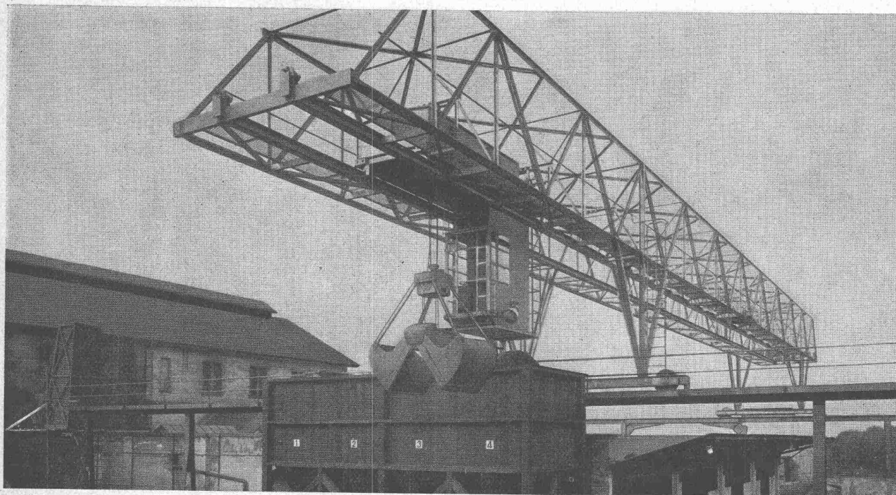
Verladebrücke in Schweisskonstruktion 2,5 t Tragkraft, 46 m Länge
