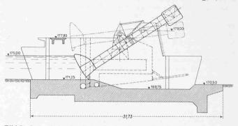
Bild 3. Querschnitt durch das hydraulisch-automatische Segmentwehr, Masstab $1\!:\!420$
