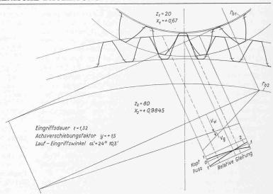
Beispiel 6. V-Getriebe 20/80 Zähne, maximale positive Profilverschiebung.
