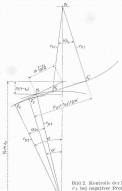
Bild 2. Kontrolle der Kopfkreise  $r'_k$  bei negativer Profilverschiebung und Bestimmung der Evolventen-Fusskreisradien  $r_p$
