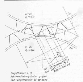
Beispiel 5. V-Getriebe 25/25 Zähne, maximale positive Profilverschiebung.
