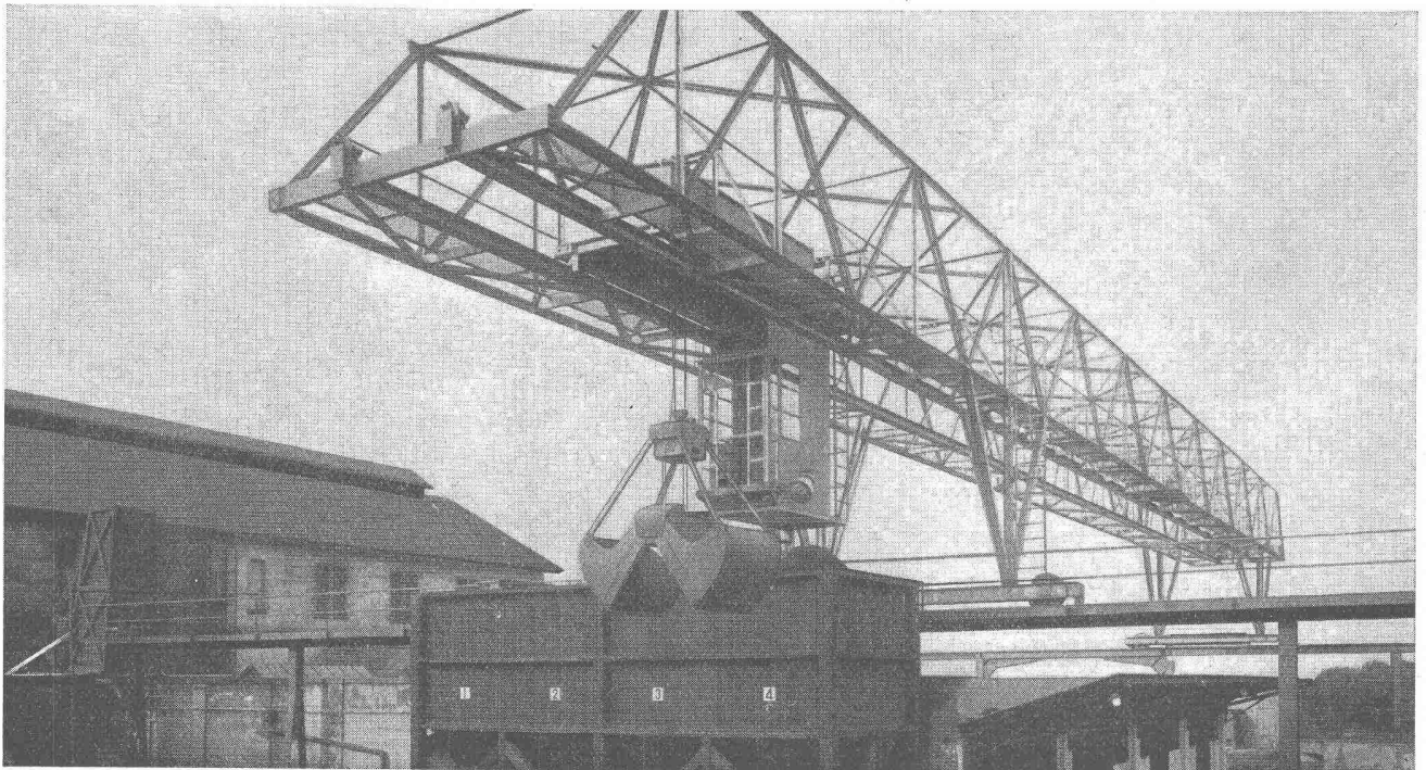
Verladebrücke in Schweisskonstruktion 2,5 t Tragkraft, 46 m Länge
