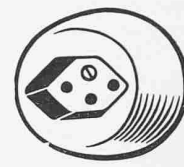
Bild 7b. Neue Steckdose für Räume mit beschränkter Zulassung
