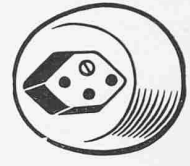
Bild 7b. Neue Steckdose für Räume mit beschränkter Zulassung
