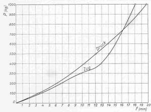
Bild 10. Federkennlinie
