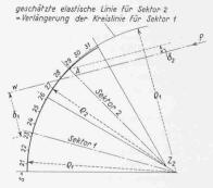
Bild 8. Konstruktion der elastischen Linie
