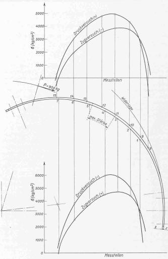
Bild 11. Spannungsverlauf der Kupplungsfeder. Masstab der Feder 1:7,5
