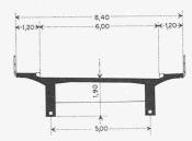
Bilder 19 und 20. Thurbrücke in der Mühlau bei Bazenheid (Kt. St. Gallen) 1952. Plattenbalkenbrücke mit zwei Trägern in einer Oeffnung  $l=42\,$  m, konstante Bauhöhe  $d=190\,$  cm, d/l=22,1. Spannkraft  $V=2500\,$  t mit einem Spannblack
