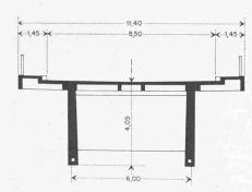
Bilder 21 und 22. Donautalbrücke Untermarchtal 1952/53. Durchlaufende Balkenbrücke mit zwei Trägern über fünf Oeffnungen, l=62+70+70+70+62 m mit Kragarmen l=11,5 m und Koppelpatten l=9 m an den Brückenenden, Gesamtlänge L=375 m. Konstante Bauhöhe d=405 cm, l/d=17,3. Spannkraft V=3600 t mit einem Spannblock. Quervorspannung durch «Leoba»-Spannglieder  $12\times 5$   $\phi$ , V=24 t, alle 50 cm. Herstellung in zwei ge-
