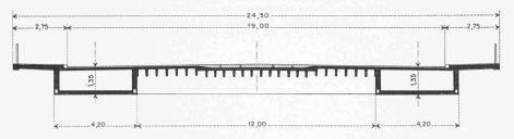
Bilder 15 und 16. Rosensteinbrücke über den mit gestaffelten Schlaufen, in Rahmenecke V=Neckar in Stuttgart 1952. Zweigelenkrahmen mit einer Spannweite l=68,51 m und veränderlicher Bauhöhe, Mittelfeld d=136 cm, l/d=50.4, 3680 t, Querträger in Abständen von 306 cm durch Rahmenecke  $d=405\,\mathrm{cm}$ . Riegel aus zwei Kastenträgern in 16,20 m Axabstand, kurze starke Stiele in Dreieckform mit einem regulierbaren Fussgelenk, Spannkraft des Riegels abgestuft
