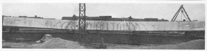
Bild 6. Bruchbild des Versuchsbalkens A der Deutschen Bundesbahnen. Spannweite l=20 m, Bauhöhe d=100 cm. Spannkraft 450 t mit 144 Litzen, 7 Drähten 2,5  $\phi$ , Bruchlast 2 P = 174 t, mittlerer Abstand der Risse 46 cm, Bruchsicherheit 2,9
