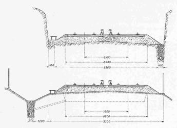
Bild 1. Normalprofile für Vororts- und Untergrundbahnen; 1:150
