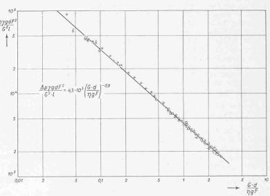
$\operatorname{Bild}$  3. Druckabfall in porösem Filtermaterial in dimensions loser Darstellung
