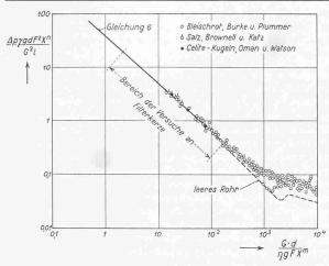
Bild 5. Vergleich der Versuche an einer Filterkerze mit Messungen an Füllkörpersäulen
