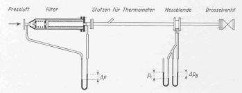
Bild 1. Versuchsanordnung für die Druckabfallmessungen an einer Filterkerze
