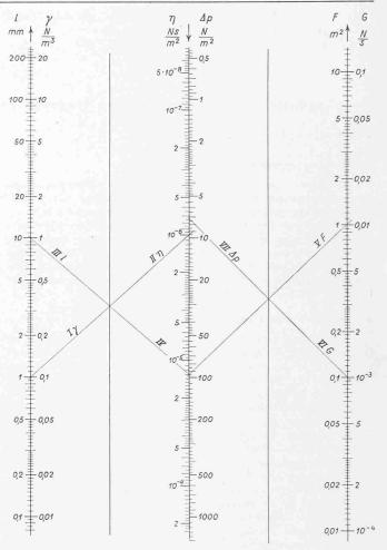
Bild 4. Nomogramm zur Berechnung des Druckabfalles in Filtern aus Quarzmaterial QR 10, gültig für leere Filter und  $Re=\frac{G\cdot d}{\eta\,g\,F}<3$
