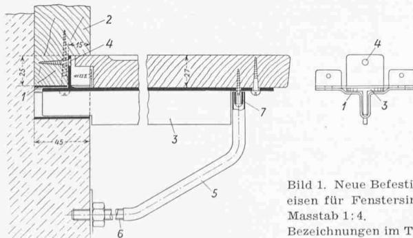
Bild 1. Neue Befestigungs-eisen für Fenstersimse. Masstab 1:4. Bezeichnungen im Text.
