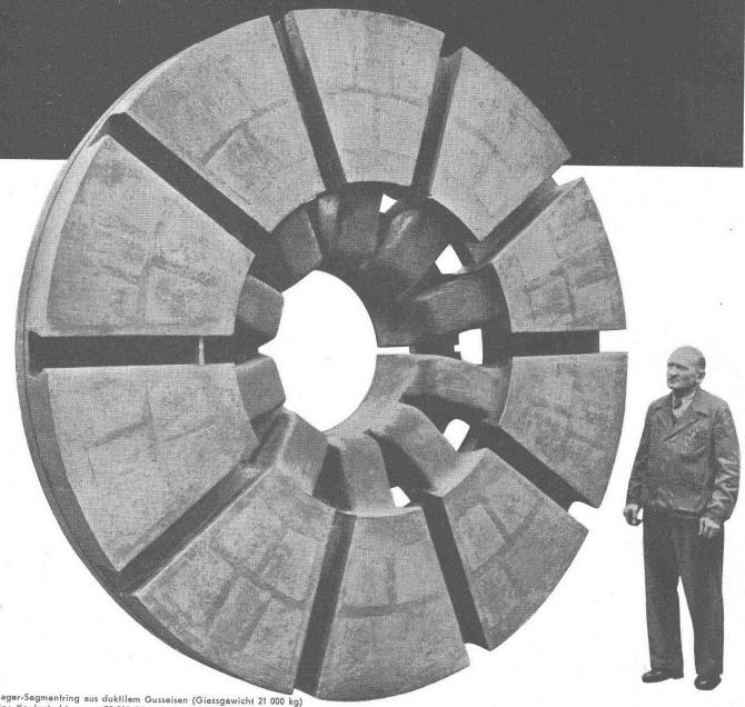
Spurlager-Segmentring aus duktilem Gusseisen (Giessgewicht 21 000 kg)
