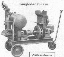
Leistungen 1—500 I/sek. Kein Bodenvenfil. Keine Klappe im Saugstutzen. Keine Hilfs-Vakuum-Pumpe. Jederzeitiges automatisches Ansaugen auch nach Lufteinfritt im Saugrohr. Keine reibenden, sich abnützenden Dichtungsflächen, daher störungsfrei auch bei Schlamm-, Sand- und Kiestörderung.
