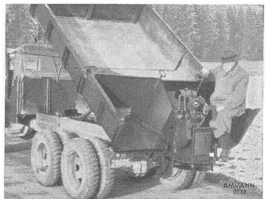
Bild 1. Tellersandstreuer mit Motor
