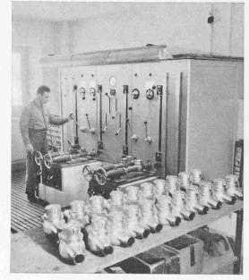
Fig. 11. Essais de compteurs à la station d'étalonnage
