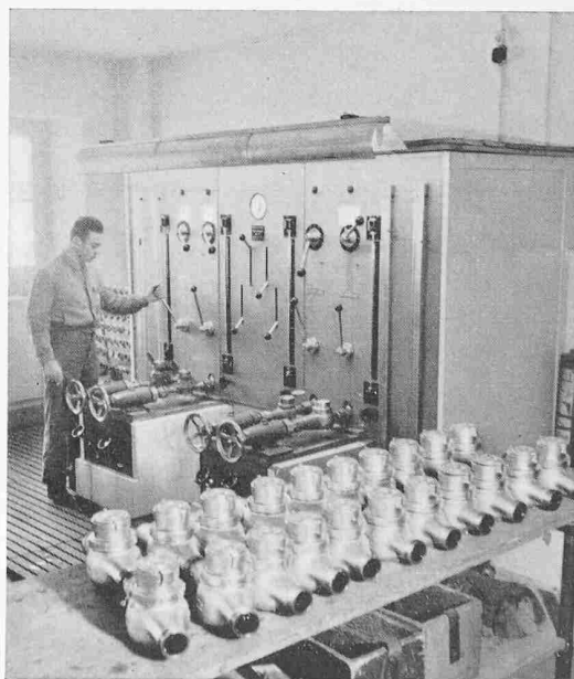
Fig. 11. Essais de compteurs à la station d'étalonnage
