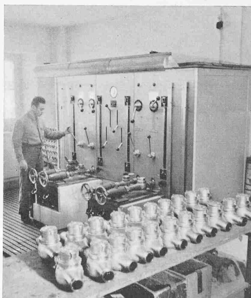
Fig. 11. Essais de compteurs à la station d'étalonnage
