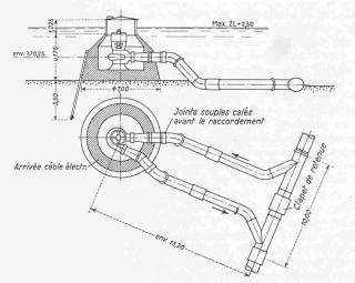
Fig. 3. Groupe moto-pompe centrifuge (pompe du lac) destiné à augmenter le débit de la conduite d'alimentation de l'usine de pompage de la Coulouvrenière. ZL = zéro Léman
