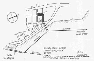
Fig. 14. Plan de situation et emplacement de la station de filtration projetée (1) des eaux du lac
