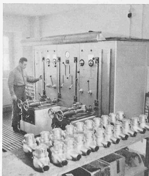
Fig. 11. Essais de compteurs à la station d'étalonnage
