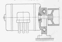
Bild 9. Zweckmässige konstruktive Lösung für die Anordnung eines exzentrisch gelagerten Motors
