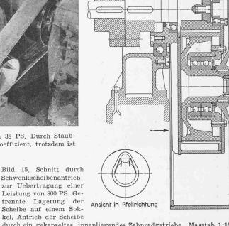
Schwenkscheibenantrieb zur Uebertragung einer Leistung von 800 PS. Getrennte Lagerung der Scheibe auf einem Sokkel, Antrieb der Scheibe
