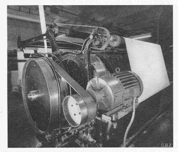
Bild 6. Antrieb von  $9.5~\mathrm{PS}$  an Stoffrauhmaschine. Die Antriebsscheibe ist schwenkbar gelagert und verhindert jedes Gleiten des Treibbandes
