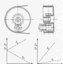
Bild 10. Exzentrisch gelagerte Treibscheibe mit selbsttätiger Sicherung gegen Gleiten
