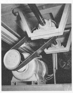
Bild 4. Transmissionsantrieb von 18 PS durch eine Schwenkscheibe
