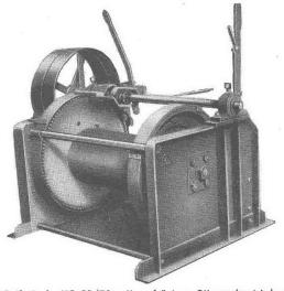
Seilwinde KS 23/70 mit gefrästem Stirnradgetriebe
