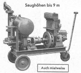
Leistungen 1-500 l/sek. Kein Bodenventil. Keine Klappe im Saugstutzen. Keine Hilfs-Vakuum-Pumpe. Jederzeitiges automatisches Ansaugen auch nach Lufteintritt im Saugrohr. Keine reibenden, sich abnützenden Dichtungsflächen, daher störungsfrei auch bei Schlamm-, Sand- und Kies-
