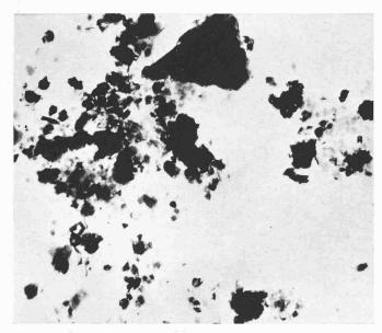
Bild 8. Belgischer Quarzsand im Anlieferungszustand, sedimentiert, Vergrösserung 10 000fach
