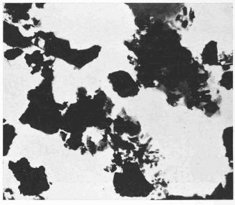
Bild 9. Belgischer Quarzsand, zerstampft, sedimentiert, Vergrösserung  $10\ 000 {\rm fach}$
