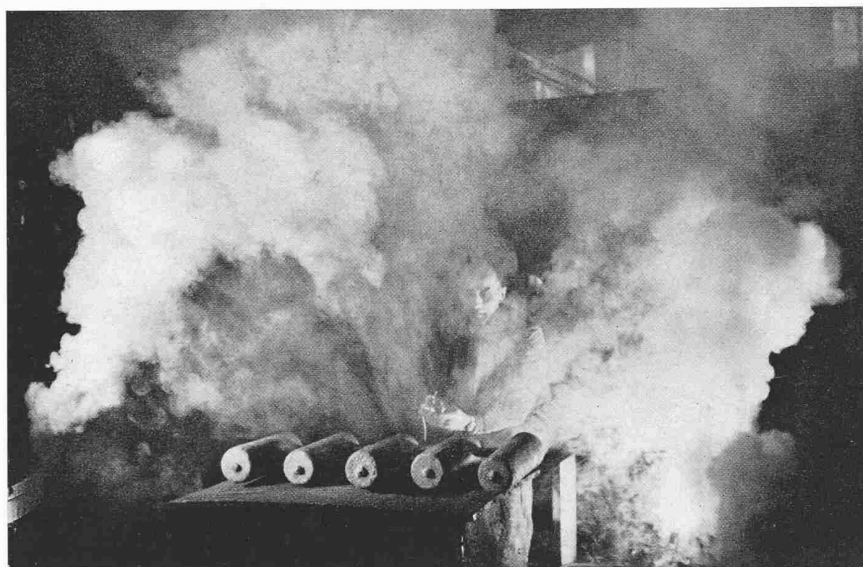
Bild 14. Durch Rauchentwicklung wurde die Raumluft um den Arbeitsplatz des Abbrenners sichtbar gemacht. Es zeigt sich, wie die im Arbeitstisch eingebaute Absaugvorrichtung die Staubatmosphäre des Arbeitsraumes an den Arbeitsplatz zieht.
