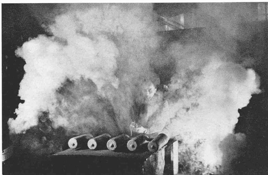
Bild 14. Durch Raumentwicklung wurde die Raumluft um den Arbeitsplatz des Abbrenners sichtbar gemacht. Es zeigt sich, wie die im Arbeitstisch eingebaute Absaugvorrichtung die Staubatmosphäre des Arbeitsraumes an den Arbeitsplatz zieht.
