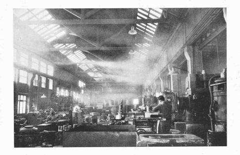
Bild 13. Die durch Rauchentwicklung sichtbar gemachte Raumluft steigt entsprechend der künstlichen Entlüftung mit etwa 1 m/min. gleichmässig nach oben
