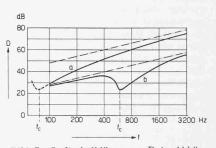
Bild 7. Luftschalldämmung D in Abhängigkeit von der Frequenz fc Strichpunktiert = Massengesetz a Backsteinwand, 500 kg/m<sup>2</sup>  $f_c = 80 \text{ Hz}$  $f_c = 600 \; \mathrm{Hz}$ b Gipsdielen, 50 kg/m<sup>2</sup>
