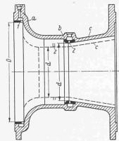
Bild 1. Doppeldüsenrohr
