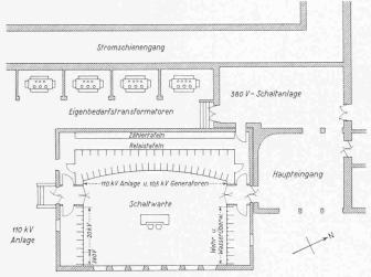
Bild 54. Grundriss der Schaltwarte, Masstab 1:400
