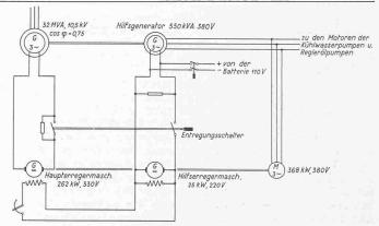
Bild 50. Prinzipielles Schaltschema der Erregung
