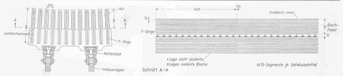
Bild 46. Blechpaket des Generatorständers, Masstab 1:10
