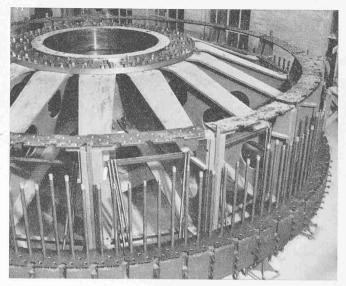
Bild 47. Schichten des Läufer-Blechpaketes
