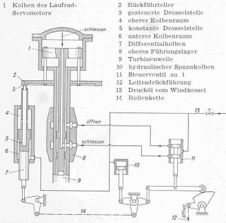
Bild 41. Prinzipschema der Laufradrückführung
