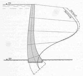
Bild 3. Normalverschiebungen des Hauptprofils der Salzasperre unter Wasserlast nach Rechnung und Versuch, Mauerdimensionen 1:1000, Normalverschiebungen 5:1
