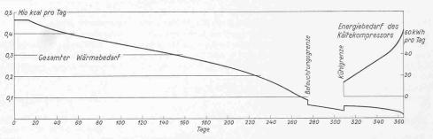
Bild 10. Wärmebedarf und Energiebedarf des Kältekompressors während eines Normaljahres, geordnet nach verschieden kalten Tagen
