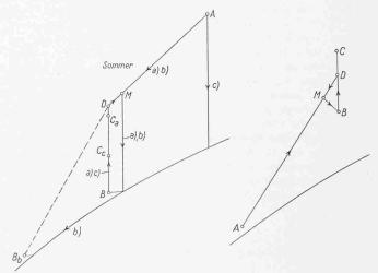
Bild 8. Ix-Diagramm für den Umluftbetrieb im Sommer, a, b, c = Zustandsänderungen bei den verschiedenen Verfahren
