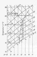
Bild 10. Ix-Diagramm einer konventionellen Anlage
