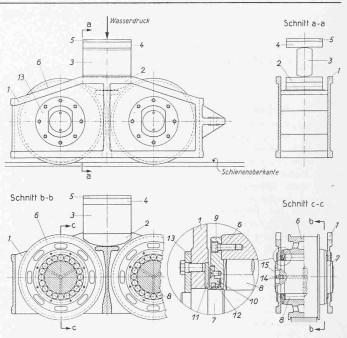
Bild 15. Laufwagen zur Unterschütze, Masstab 1:45
