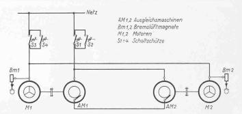
Bild 23. Schaltung der Windwerkmotoren für elektrischen Gleichlauf
