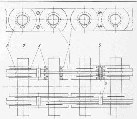
Bild 18. Kettenlaschen, Masstab 1:12 5 Halteschrauben 1 Kettenlaschen 3 Nichtrostende Zwischenscheibe 6 Seeger-Sicherungen 2 Kettenbolzen
