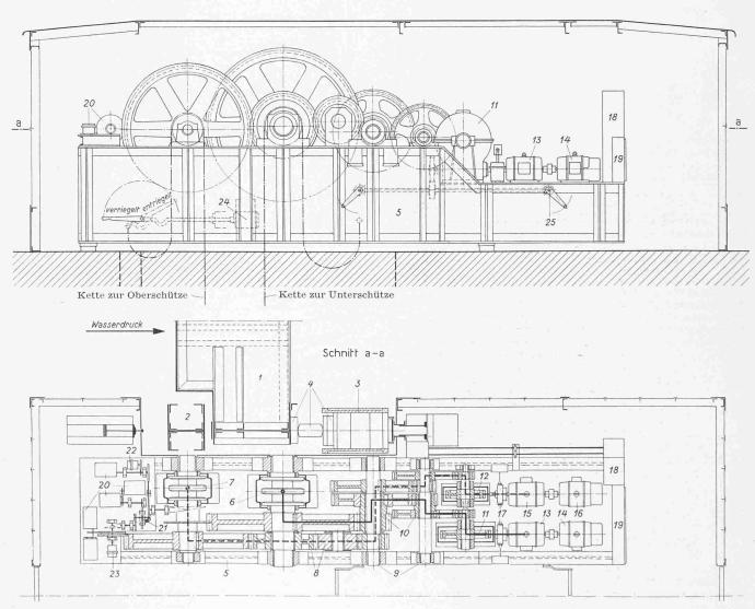
Bild 19. Aufzugwindwerk, Masstab 1:80
