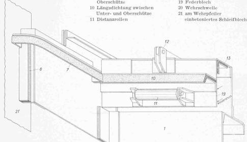
Bild 17. Schema der Dichtungen (Oberschütze entfernt, von der Unterschütze ist nur der obere Teil dargestellt)
