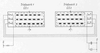
Bild 24. Schaltung zur Gleichlaufüberwachung der Windwerkmotoren
