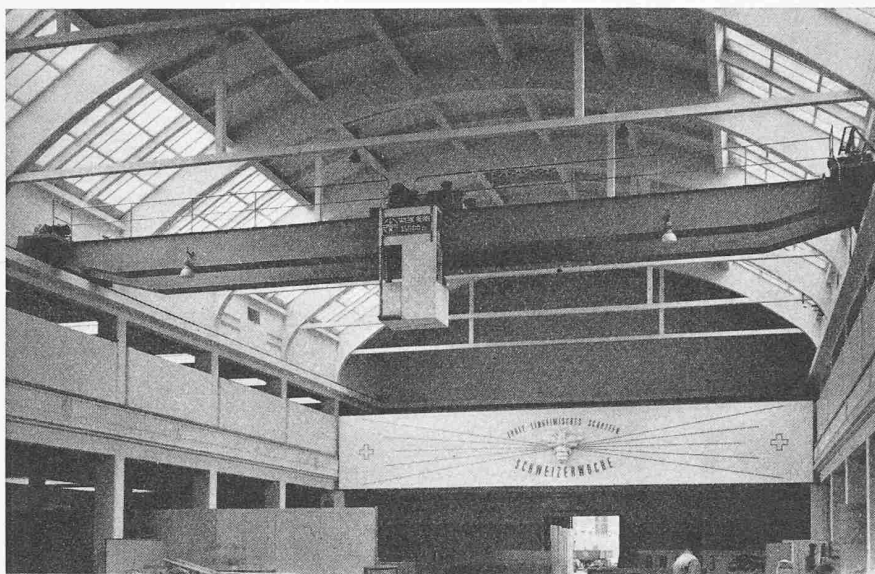
Bild 1 (links). Der 15 t-Kran in der Halle III der Mustermesse in Basel
