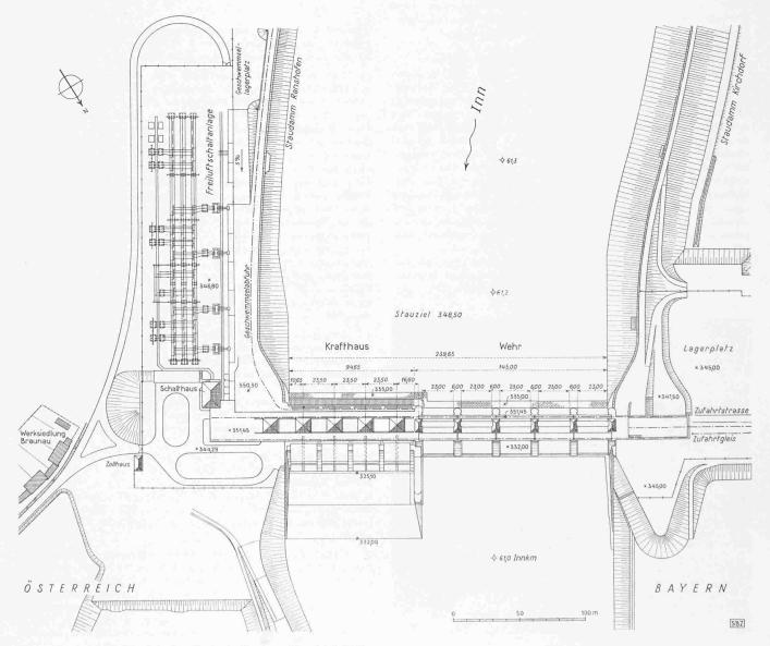
Bild 3. Lageplan des Kraftwerkes Simbach-Braunau, Masstab 1:3000
