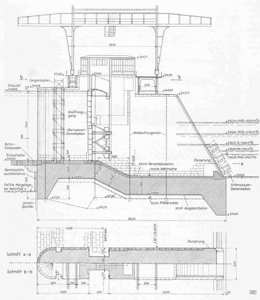
flacher Neigung in den 3 m tiefer liegenden Sturzboden über. Die gepanzerte Schwelle am Ende des Sturzbodens verhindert die Ausbildung eines schädlichen Wehrkolkes unmittelbar hinter dem Wehrboden.
