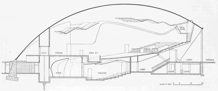
Bild 9. MIT-Auditorium, Längsschnitt 1:300
