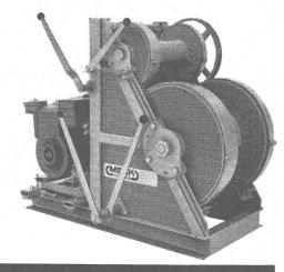
Doppeltrommelwinde Zugkraft 2500/500 kg mit Benzinmotor
