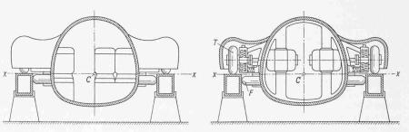
Bilder 5 und 6. Querschnitt des vorgeschlagenen Fahrzeuges durch den Passagierraum bzw. durch den Motorenraum
