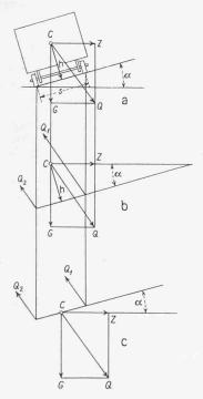
Bild 2. a und b Kräftespiel des heutigen Fahrzeuges in der Kurve, c Kräftespiel des vorgeschlagenen Fahrzeuges in der Kurve
