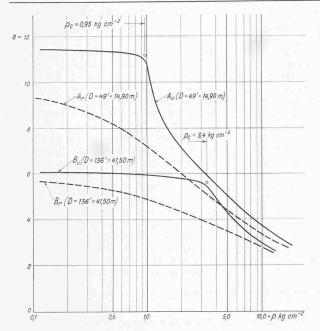
Bild 3. Konsolidationsdiagramm des Mexiko-Tons
