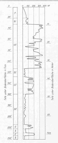
Bild 1. Typisches Bodenprofil aus Mexiko City
