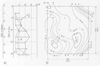
Bild 5. Baugrunduntersuchung für ein Warenhaus
