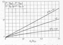
Bild 2 (berechnet nach den Formeln der Tabelle 1) zeigt, in welchem Verhältnis die Aufwertung des Anteiles  $1-\eta_h$  von Pumpen zu derjenigen bei Turbinen steht, wenn die Verhältnisse  $V_v/H_th$  und  $V/V_v$  jeweils gleich sind (der Index v bezieht sich auf das verkleinerte Versuchsmodell)
