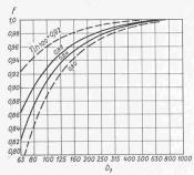
Bild 1. Faktoren f für die Wirkungsgradumdrehung in Abhängigkeit vom Laufradeintrittsdurchmesser  $D_1$  in mm bei verschiedenem Wirkungsgradniveau, gekennzeichnet durch die hydraulischen Wirkungsgrade  $\eta_{h100}$  beim Eintrittsdurchmesser 100 mm
