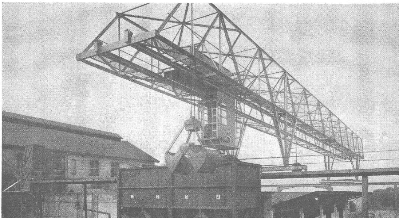
Verladebrücke in Schweisskonstruktion 2,5 t Tragkraft, 46 m Länge
