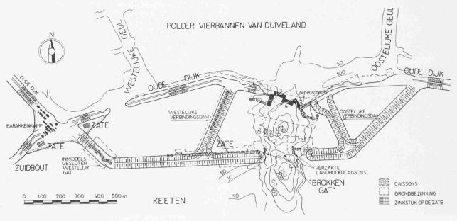
Bild 1. Der Deichschluss bei Ouwerkerk, Lageplan 1:14000 aus «De Ingenieur» vom 13. November 1953
